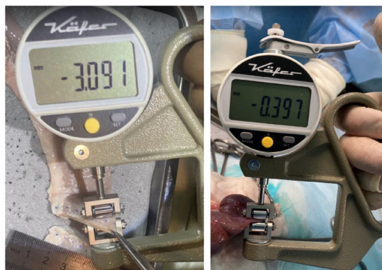
Рис. 3. Измерение толщины стенки свиной кишки (слева) и слепой кишки кролика (справа) с помощью индикаторного толщиномера
