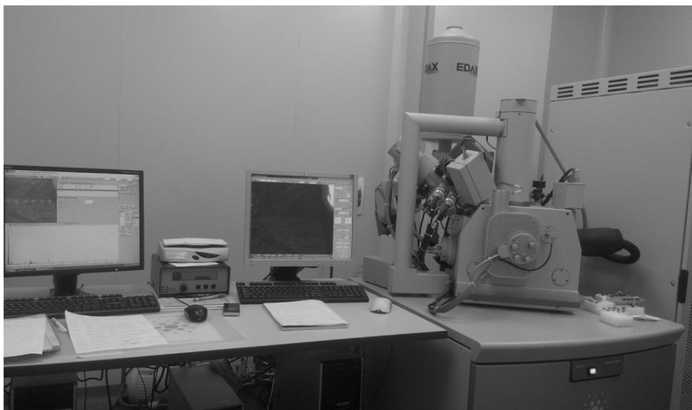
Рисунок 7 – Сканирующий электронно-ионный микроскоп Quanta 200 3D
