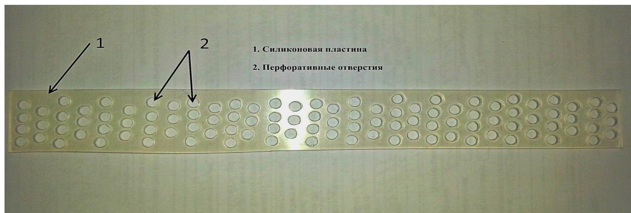
Рисунок 1 – Силиконовая пластина
