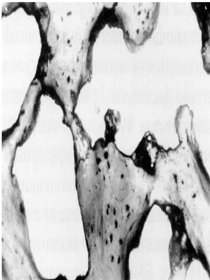
Рисунок 3.4 – Структура пористого никелида титана с образованной в нем костной тканью, через 3 месяца после имплантации (увеличение  $\times 500$ )
