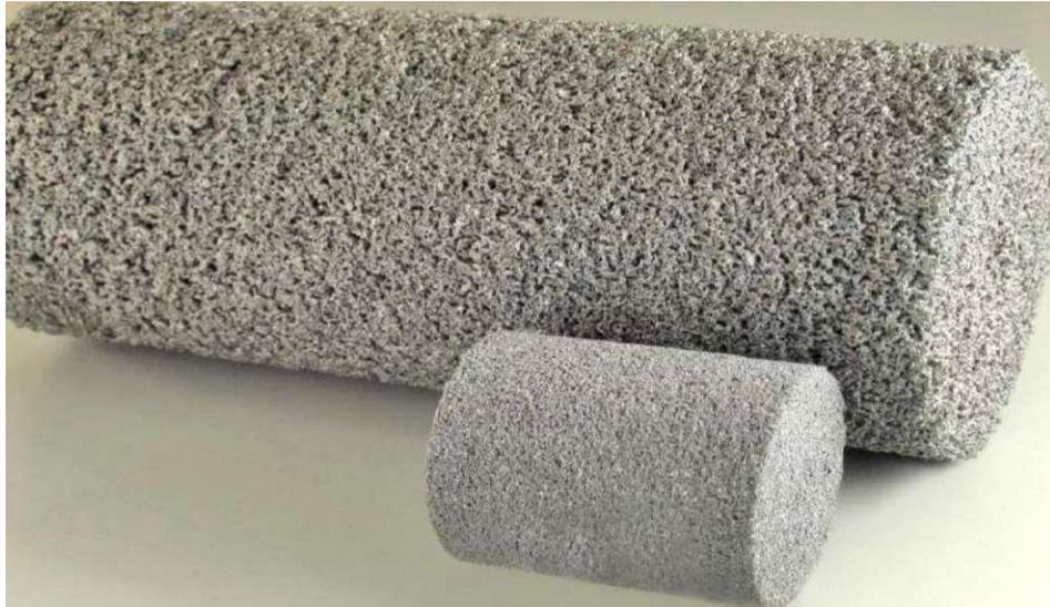
Рисунок 1.1 – Полученные методом СВС полуфабрикаты из пористого никелида титана
