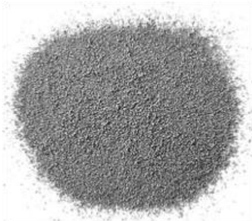
Рисунок 2.10 – Пористый никелид титана с гранулами
