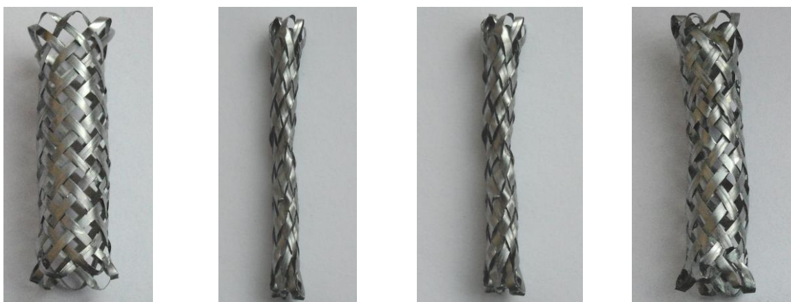
Рисунок 3. Использованные устройства из никелида титана (проявление эффекта памяти формы)
