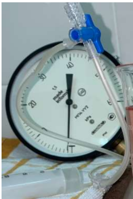
Рисунок 44 – Манометр для барометрических испытаний культи бронха
